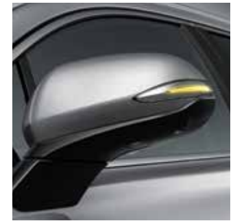
Außenspiegel in Wagenfarbe mit integriertem LED-Blinker.
