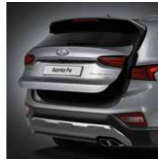
Elektrische Heckklappe mit zwei Öffnungsgeschwindigkeiten. 1
