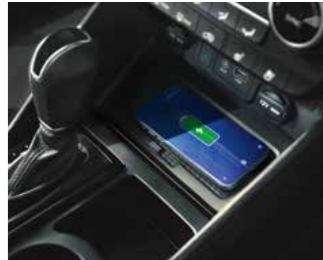
Kabelloses Aufladen Ihres Smartphones 1 , AUX-Buchse, USB- und 12 V-Buchse.
