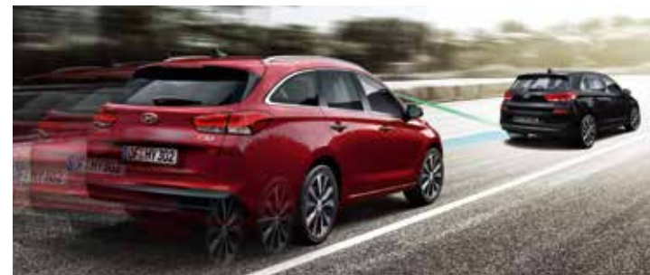
Autonomer Notbremsassistent inklusive Frontkollisionwarner und Fußgängererkennung (FCA): Das FCA-System überwacht mit Kamera und Radarsensor den vorausfahrenden Verkehr. Stellt der Notbremsassistent fest, dass eine Gefährdung durch andere Fahrzeuge (8-180 km/h) oder für Fußgänger (bis 64 km/h) besteht, löst er zunächst eine optische und akustische Warnung aus und leitet im Notfall eine Teil- oder Vollbremsung ein, sofern Sie die Bremse nicht bereits selbst betätigt haben.
