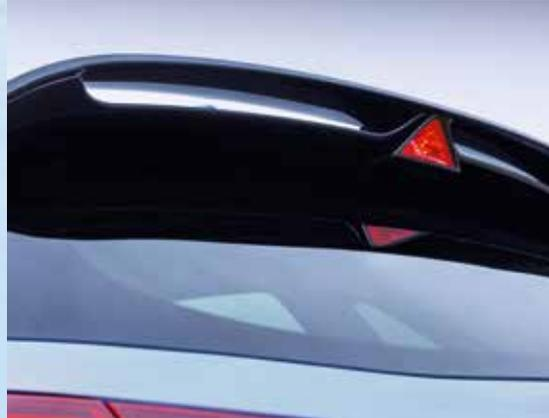
Der Heckspoiler sorgt für verringerten Auftrieb beim dynamischen Fahren.
