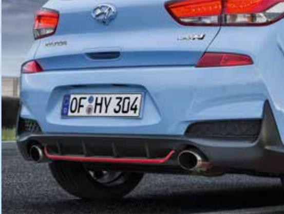
Die Sportabgasanlage mit variabler Klappensteuerung<sup>1</sup> trägt zum unverwechselbaren Sound des Hyundai i30 N Performance bei.
