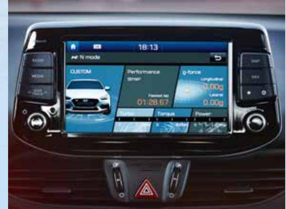
Auf dem Navigations-Display<sup>1</sup> werden auch spezielle Informationen wie G-Kräfte, Drehmoment, Rundenzeiten und Fahrmodi angezeigt.
