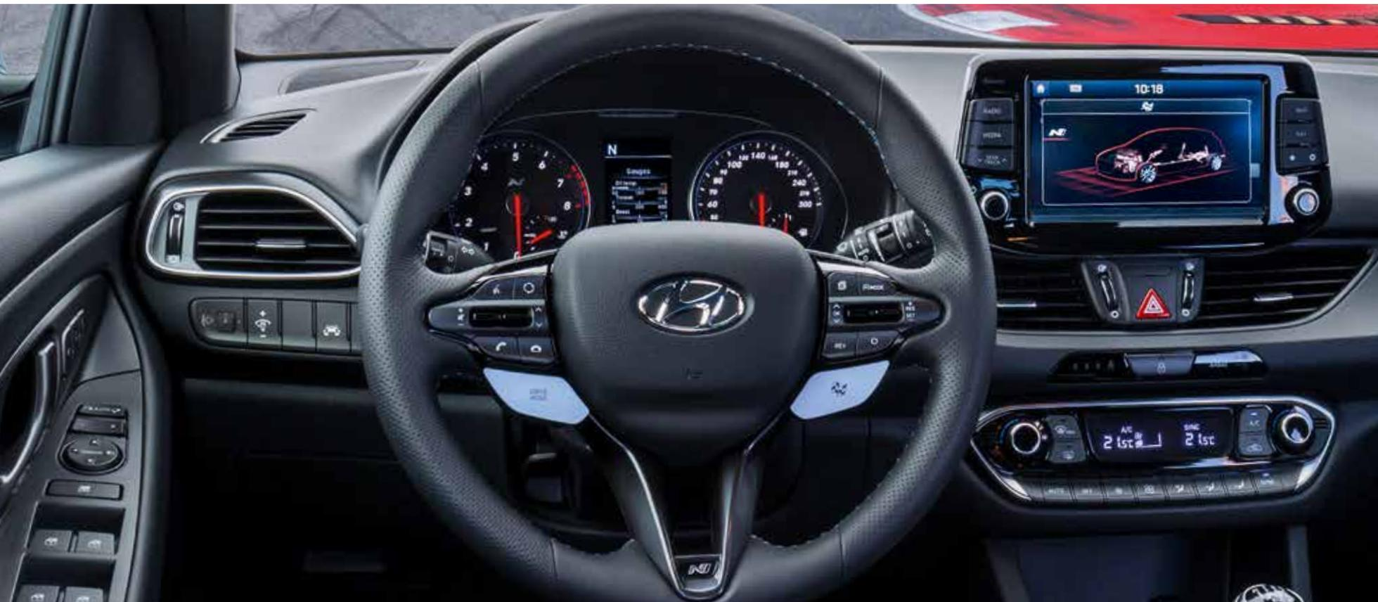
Stärker durch Daten. Auf dem optimal platzierten 8-Zoll-Touchscreen können neben zahlreichen Einstellmöglichkeiten Informationen<sup>1</sup> zu Turbo-Ladedruck, Drehmoment, Motorleistung sowie Zeitnehmer für Rundenzeiten und Beschleunigung angezeigt werden.
