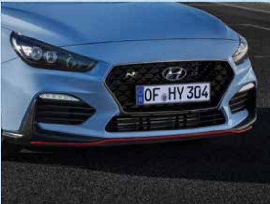
Die tiefergelegte Karosserie, der tiefergezogene Kühlergrill und die Frontlippe mit roter Zierleiste<sup>4</sup>.
