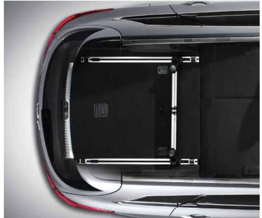
Gepäckraumordnungssystem mit stufenlos verstellbarer Trennstrebe<sup>1</sup>
